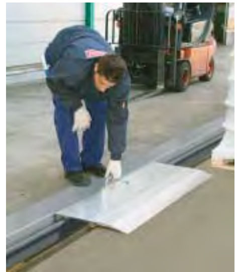
Sicheres Befahren der BB – Brücke.
